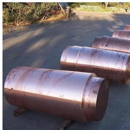
研发的无氧紫铜锭和铜排，广泛应用于大型电机的端环和导电条。
